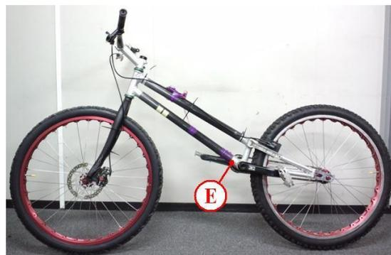
図2 CFRP 製競技用実用自転車
