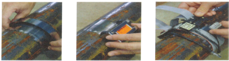
配管へのガイド波測定装置の装着
